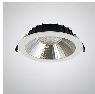
Das Downlight überzeugt durch sehr hohe Lichtausbeute, rotationssymmetrische Lichtverteilung, sehr gute Entblendung (UGR <19) und flimmerfreies Licht. Die Montage erfolgt werkzeuglos mittels vormontierter Federtechnik. Das externe Betriebsgerät (DALI, Touchdim oder PowerLine) wird separat in der Decke platziert.
