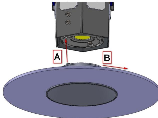
3. Die Leuchteneinheit in den Plexiglaszylinder einsetzen.
