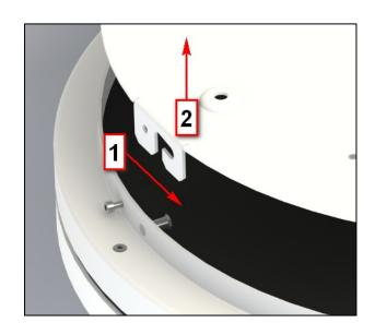
Anschließend das Deckenblech gegen den Uhrzeigersinn drehen (1) und anheben (2), die Erdungsleitung am Leuchtenkörper abziehen und die Verbindungsdrähte zwischen Betriebsgerät und LED-Platine an der 2poligen Klemme lösen.
