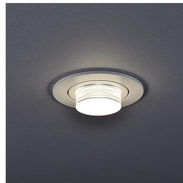
Das Gehäuse besteht aus Aluminiumdruckguss und dient gleichzeitig als passiver Kühlkörper zur optimalen Wärmeableitung. Das Besondere ist der integrierte Acrylglaszylinder mit polierten Kanten und satinierter Unterseite. An dessen Außenkante sind vier feine Linien eingefräst, die das Licht gezielt auskoppeln und als leuchtende Ringe sichtbar machen. So entsteht ein zusätzlicher Lichthof unter der Decke – ein markantes Lichtmerkmal der Serie.
