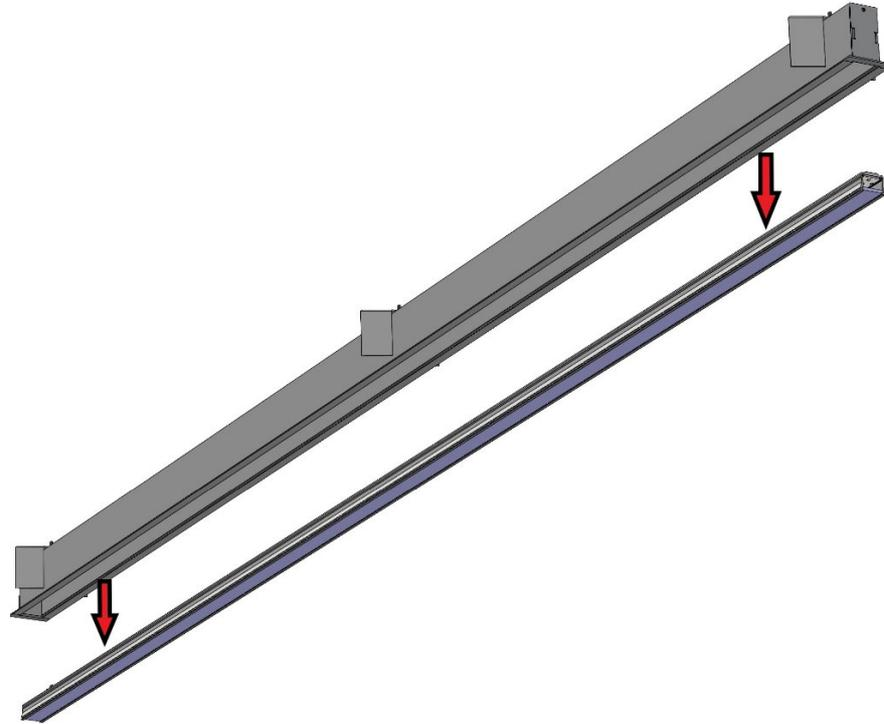
2. Das Leuchtengehäuse in die Decke einbauen.
