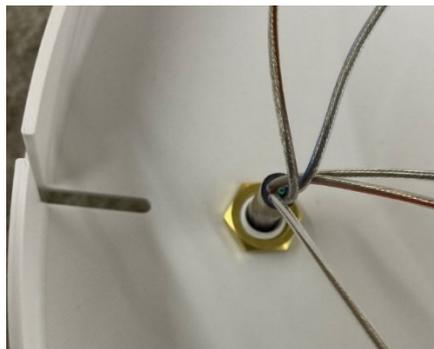
7. Leuchtenzuleitung an der Deckenplatte des Deckenbaldachines anschließen, dabei auf die Codierung der Einzeladern achten!
