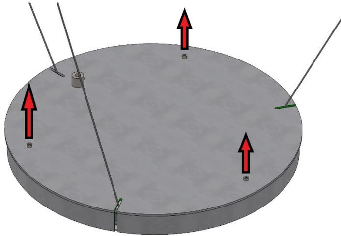
3. Deckenbaldachin an die Decke schrauben.
