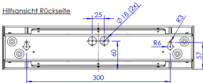
Die an der Leuchte vorhandenen Befestigungssicken dienen lediglich zum Ausgleich von Wandunebenheiten etc. Diese müssen zur Montage der Leuchte nicht verwendet werden.
